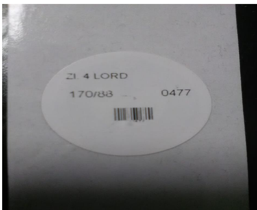
Etykieta z kodem kreskowym i tagiem RFID HF.
