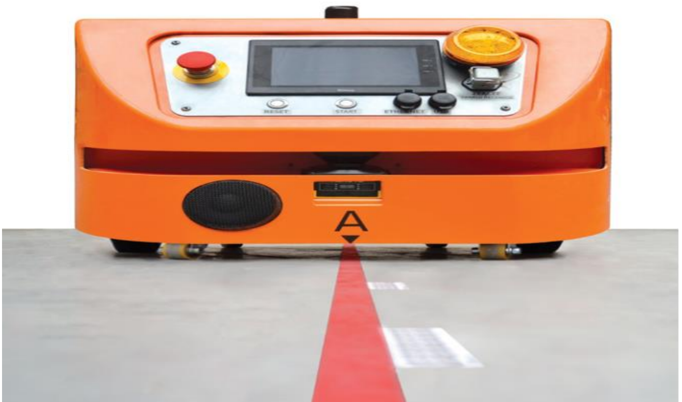
Przykładowy wózek autonomiczny nawigowany po linii kolorowej.
