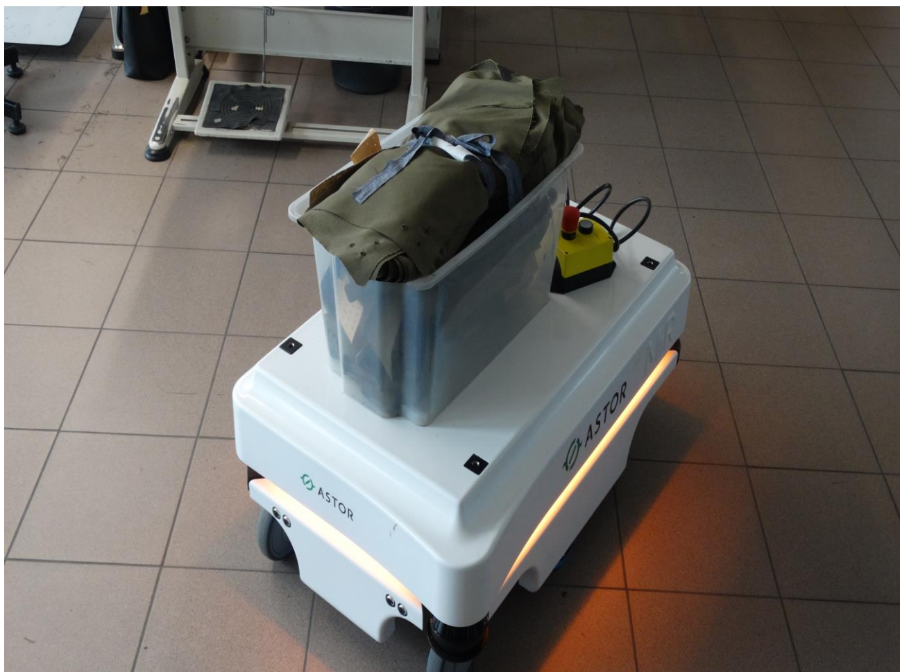
Autonomiczny robot mobilny MiR 100 podczas przewożenia pojemnika z pakietami odzieży.
