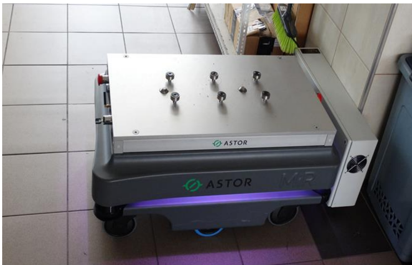
Autonomiczny robot mobilny MiR 200 na stanowisku ładowania akumulatorów.
