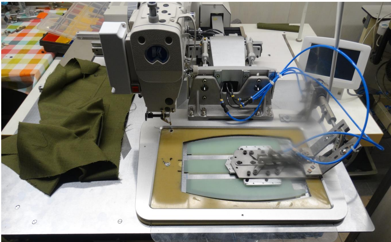
Wykonany prototyp narzędzia zamocowany na automacie.
