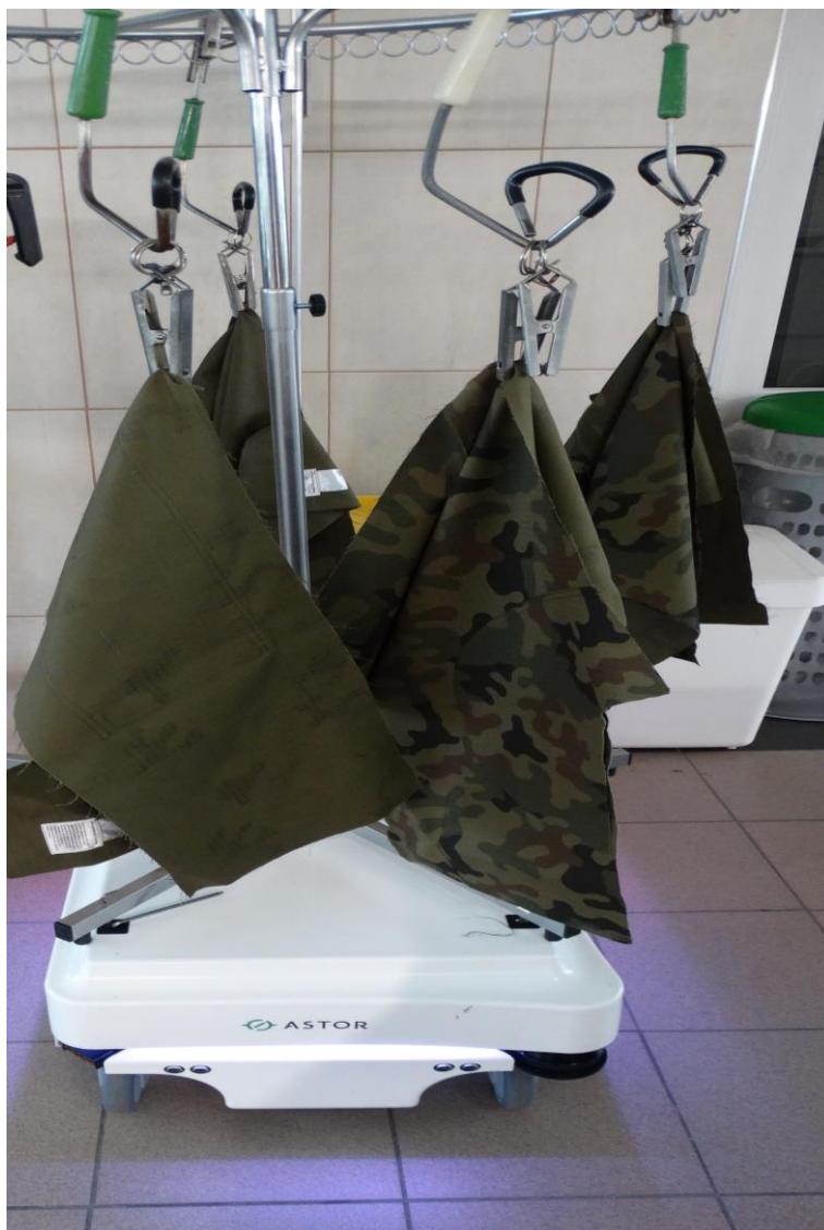
Transport elementów odzieży w stanie zawieszonym.
