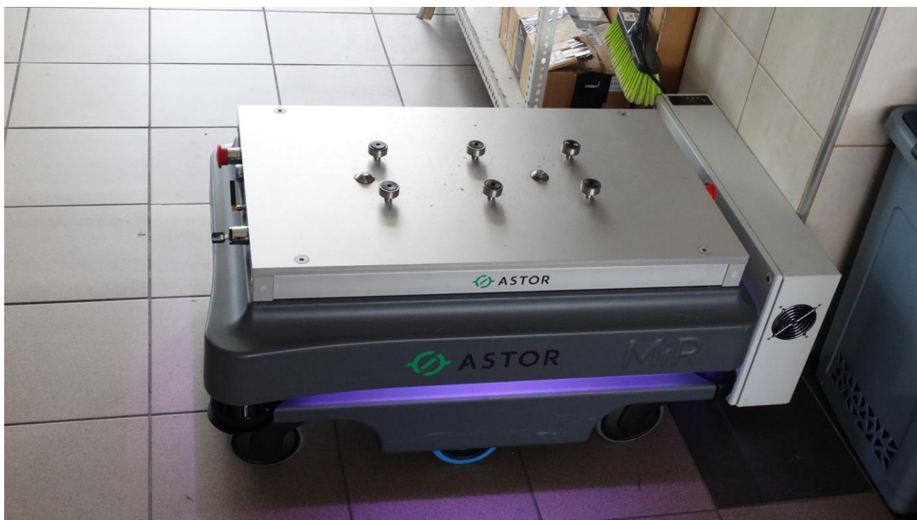
Robot mobilny AGV wykorzystywany do transportu wózków przy stacji ładowania.
