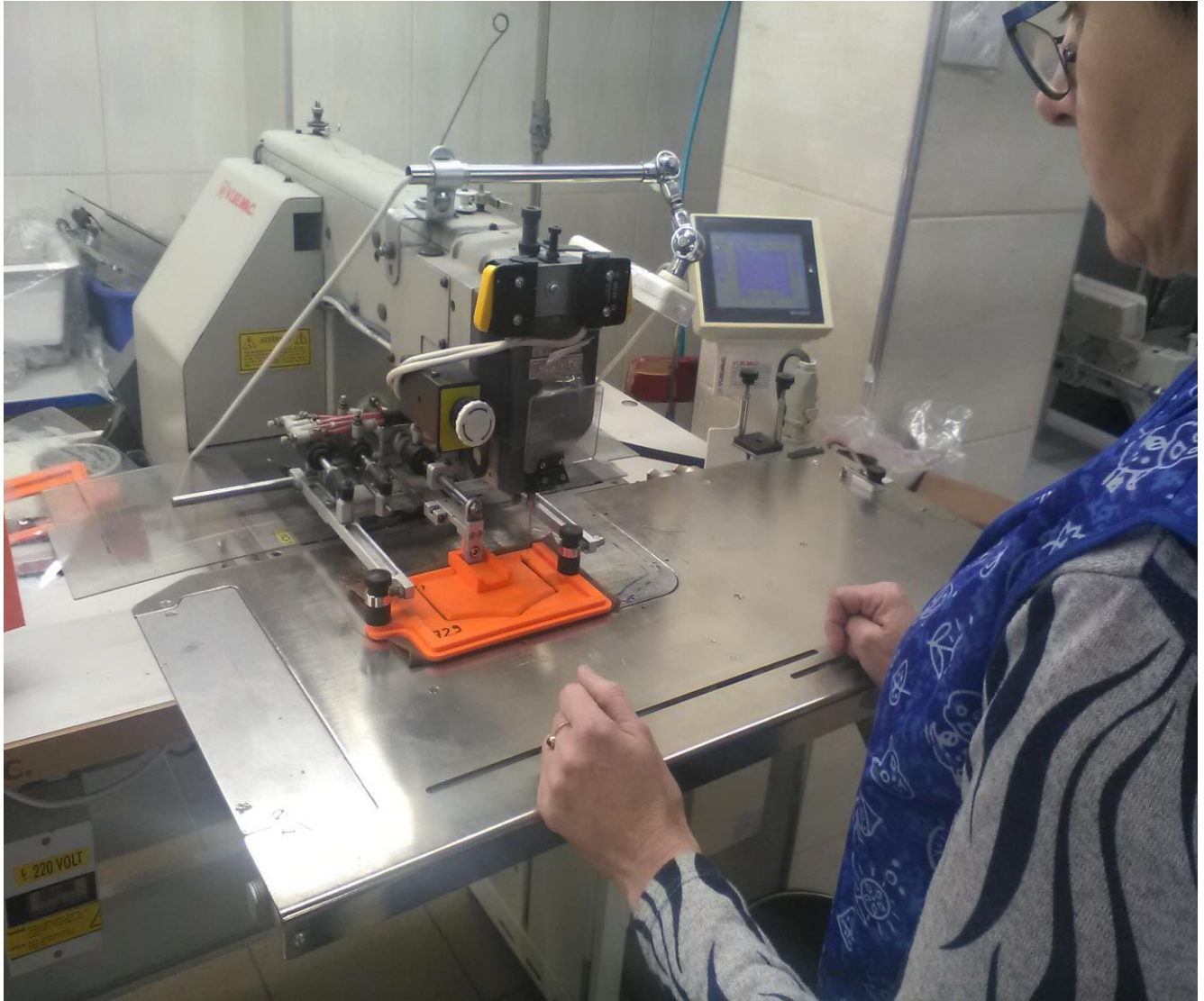
Franken - narzędzie do odszywania patki zamontowane do automatu.
